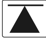
Рисунок 6.5.1 – Знак места установки домкрата
