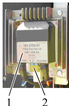
Рисунок 2.17.10 – Установка предохранителя ПН на тракторах «БЕЛАРУС-3022ДЦ.1 ранних» выпусков.
